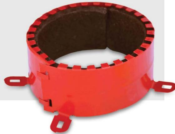
Противопожарные муфты используются в местах прохождения кабельных проходок, полимерных труб через перегородки и перекрытия. Муфта состоит из разъемного металлического корпуса и вкладыша из терморасширяющегося материала.
