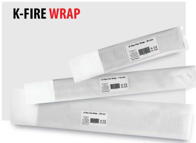
Используются в местах прохождения кабельных проходок, полимерных и металлических труб через перегородки и перекрытия. При возгорании терморасширяющийся вкладыш перекрывает отверстие в межэтажном (межстеновом) перекрытии, через которое проходит труба, тем самым в течение длительного времени препятствует распространению огня и продуктов горения в помещении.
