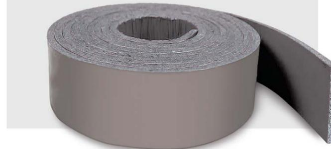
Противопожарная лента используется в местах прохождения кабельных проходок, полимерных и металлических труб через перегородки и перекрытия. Лента поставляется цельным рулоном, который разрезается на куски соответствующей длины непосредственно при установке.
