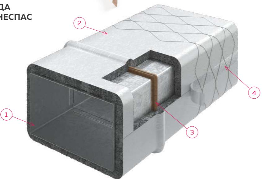
Для герметизации и уплотнения фланцевых соединений компонентов воздуховода укладываются терморасширяемая лента ТЕРМОТЕЙП. Для этого, непосредственно перед ее нанесением, рабочие поверхности протираются сухой ветошью, отмеряется необходимый отрезок, наклеивается на рабочую поверхность воздуховода и прикатывается (вручную или валиком), чтобы исключить складки и вздутия.
