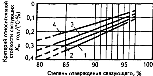
Рис. 5.10. Зависимость критерия сравнительной стойкости синтетических связующих от степени их отверждения в минераловатной плите: 1 – на фенолоспиртах марки В; 2 – на нейтрализованных фенолоспиртах марки Б; 3 – на фенолоспиртах марки Д и смоле типа СФ-3047 Н; 4 – на смоле СФ-3047 Н с модификатором АМГ-9
