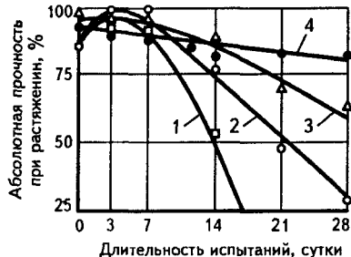
Рис. 5.3. Изменение прочности нейтрализованных фенолоспиртов марки Б при \varphi = 20 \pm 2^\circ\text{C} и t = 98 \pm 2\% в зависимости от степени их отверждения, %: 1 – 65–70; 2 – 75–80; 3 – 85–87; 4 – 93–95
